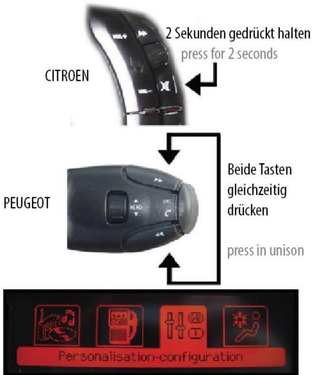
Um weiterhin den Bordcomputer nutzen zu können und das Menü aufzurufen, müssen Sie bei Fahrzeugen von CITROËN die „Stummschaltungstaste“ zwei Sekunden lang gedrückt halten, bei Fahrzeugen von PEUGEOT müssen Sie beide Titeltasten gleichzeitig drücken.
